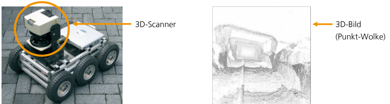
Abbildung 5: Kurt3D (links) 3D-Bild (rechts) (Quelle: Kurt3D Fraunhofer IAIS)
