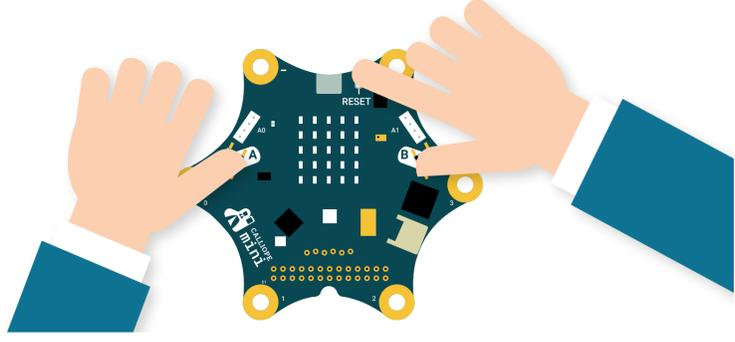
Drücke die Tasten A, B und Reset. Nach 5 Sekunden lässt Du Reset los. Sobald ein Muster auf der LED-Matrix erscheint, lässt Du auch A und B los. Übertrage das Muster der LEDs auf das Tablet.
